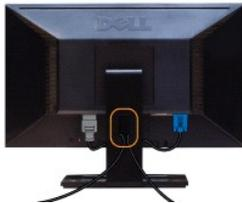
Después de conectar todos los cables necesarios al monitor y al PC, (consulte [Conectar su monitor](#) para conectar los cables), utilice la ranura de sujeción de cables para organizarlos correctamente tal y como se muestra arriba.
